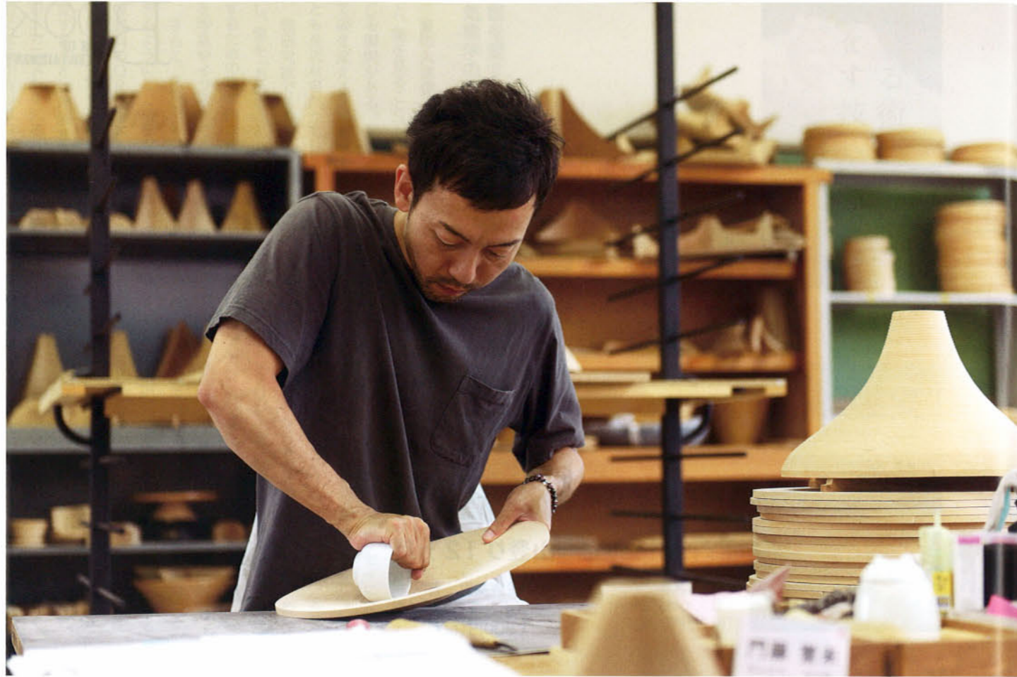
型上げ作業。平面状の巻き板を湯のみ茶碗で押し出して立体にし、製品ごとの型に当て、形を作る。手で感触を確かめながら、へらや棒でミリ単位まで微調整。繊細で美しい形状に仕上げる。これぞ、まさしく職人技だ。
