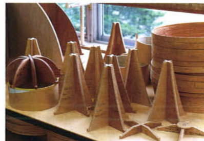
図面データから、製品ごとの型を機械で作る。立体に型上げた巻き板に当てて形を作る。
