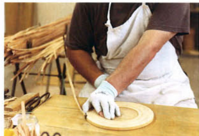
厚さ1mm、長さ1800mmのテープ状のブナ材をボンドで継ぎ足しつつ、コイル状に巻き上げ、巻き板を作る。
